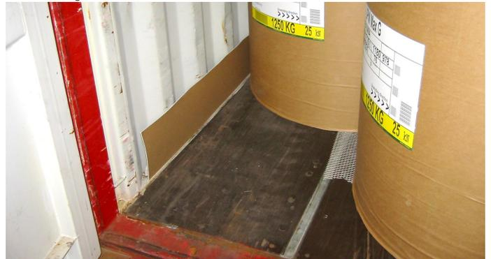
Ungleichmäßige Wände und Böden von Containern und Eisenbahn Waggons können Waren beschädigen. Das kann durch Flachstreifen an den Seiten und auf dem Boden verhindert werden.
